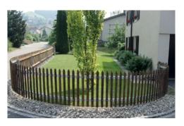
Eine Montage des Palisadenzaunes ist an Holzpfosten gerammt oder in T-Stahlpfosten einbetoniert möglich. Sowie mit Holztraverse halbrund oder U-Stahltraversen.
